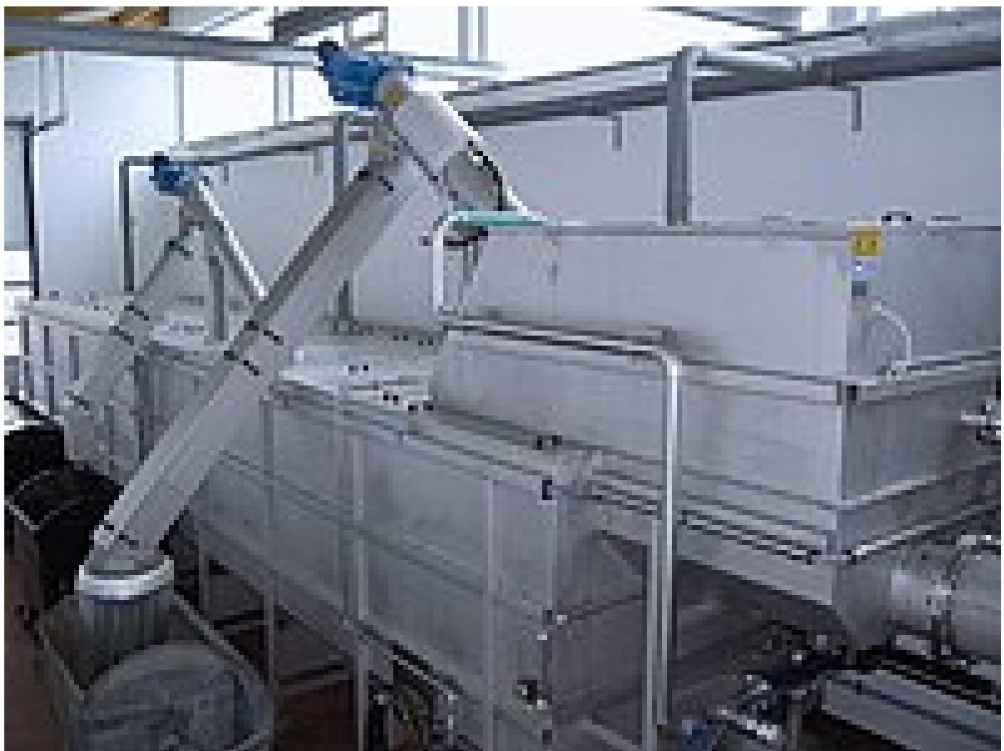
Многофункциональные комбинированные установки для глубокой и надёжной механической очистки сточных вод
