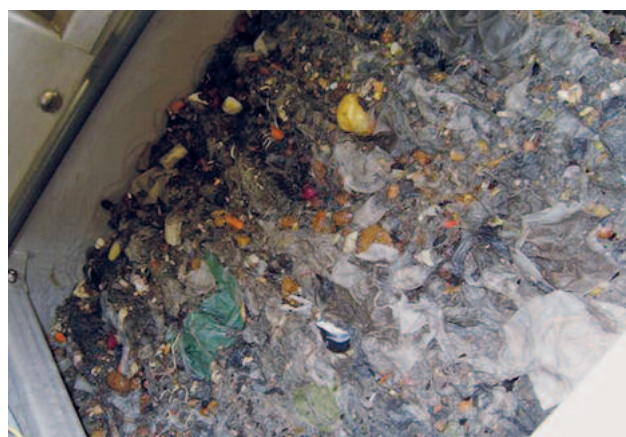
Ступенчатая решетка HUBER STEP SCREEN® SSF: высокая степень механической очистки благодаря ширине щели малого размера и образуемому слою отбросов, а также эффект самоочистки благодаря подвижному ламельному элементу.
