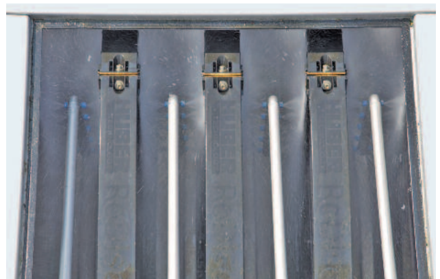
Зовнішнє промивання фільтруючих дисків з використанням фільтрату— відсутня зовнішня подача промивної води.
