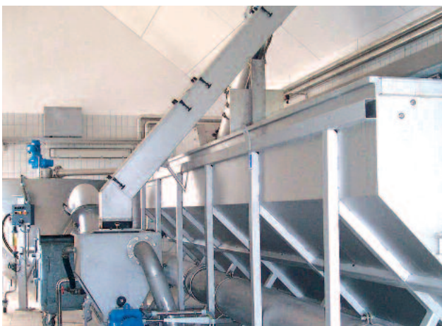
Вивантаження відходів з установки Ro 5 у промивний прес WAP/SL
