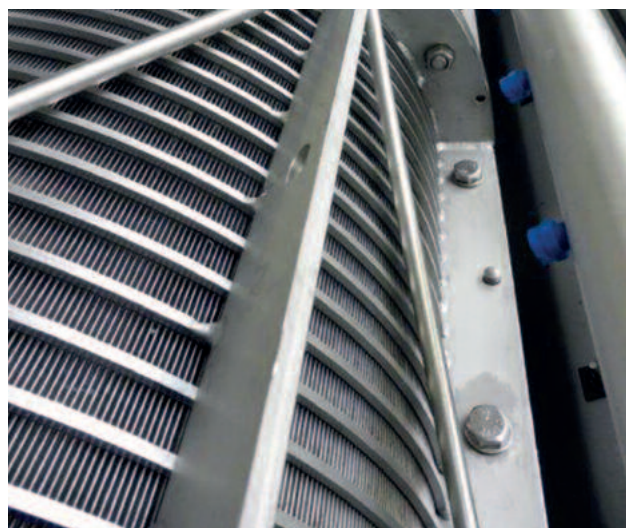
Міцний клиноподібний сітчастий барабан з нержавіючої сталі
