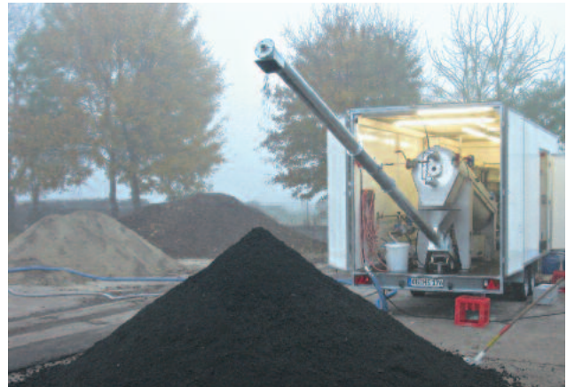
Зневоднення, яке здійснюється по договору, за допомогою HUBER Q-PRESS®, встановленого у причепі
